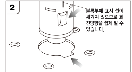
네 모서리에 있는 다리 고정용 구멍에 다리 파이프의 블록부를 맞춰 끼웁니다. (이 때, 다리 파이프 선단의 돌기가 반대쪽으로 나와 있는지 확인하십시오)
